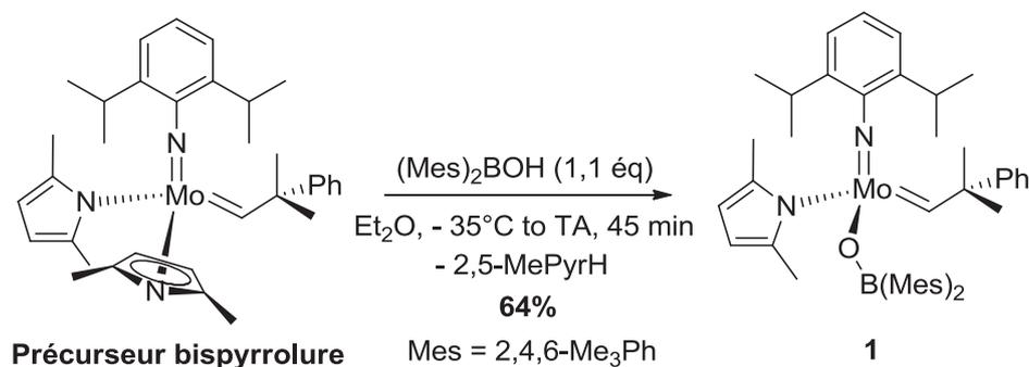
**Schéma 1** : Synthèse et isolement du complexe mono boroxy pyrrolure **1**
