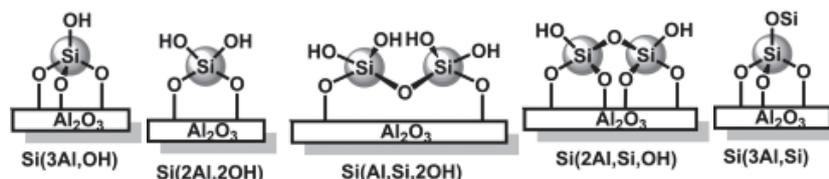
Figure 5. 17 Représentation schématique des configurations probables entre -80 et -95 ppm<sup>14</sup>
