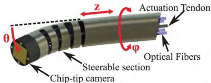
FIGURE 4.13 – Endoscope miniature robotisé permettant une inspection de l'oreille moyenne en passant par la trompe d'Eustache [24]
