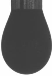
**Figure 3-17 : Photographie d'une goutte pendante de PVA permettant de mesurer la tension de surface liquide / air**
