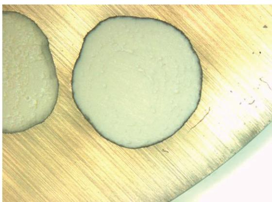
Figure IV-1 : Cliché d'une section d'une bille de catalyseur piégée dans de la résine
