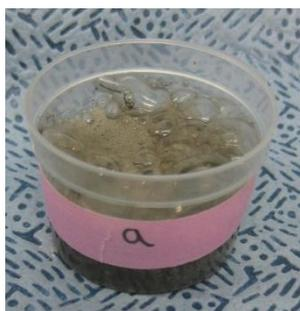
Figure IV-10 : Photo du dégagement de CO<sub>2</sub> lors de l'acidification d'une pastille d'argilite.
