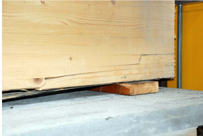
Figure 1.48. Rupture de la première poutre BLC. Développement de la fissure de traction au niveau d'un nœud et décollement du CFRP. Vue d'un tronçon scié de la poutre.
