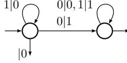
FIGURE 7.2 – Transducteur séquentiel réalisant la transposée de  $\alpha_0$
