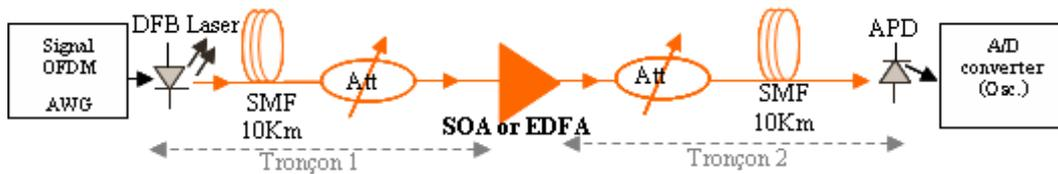
Figure 148 : Schéma d'expérience de l'amplification d'une transmission OFDM
