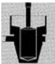
Figure 20 : Cellule de mesure du Low Shear 30
