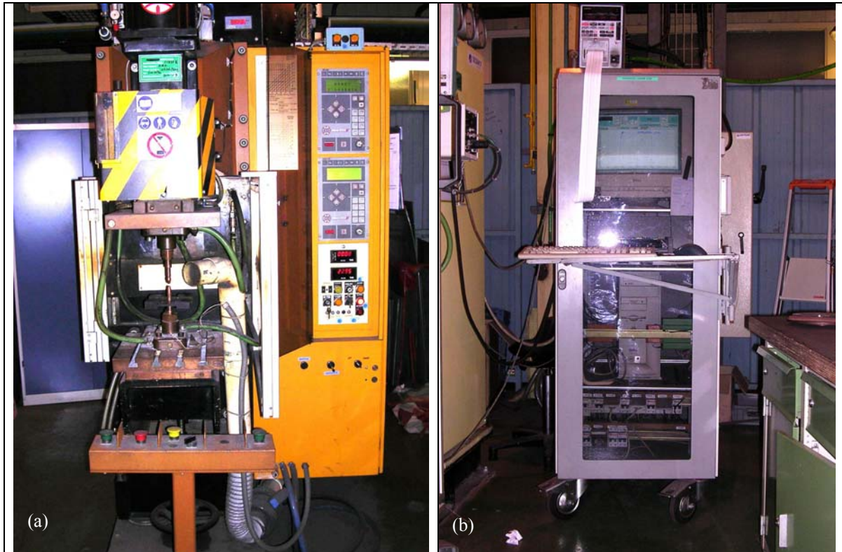
Fig. 2.2: Appareillage d'essai de soudage par points : a) Machine de soudage «ARO», b) Acquisition de signaux de soudage «Labview» et current signal checker «Miyashi »
