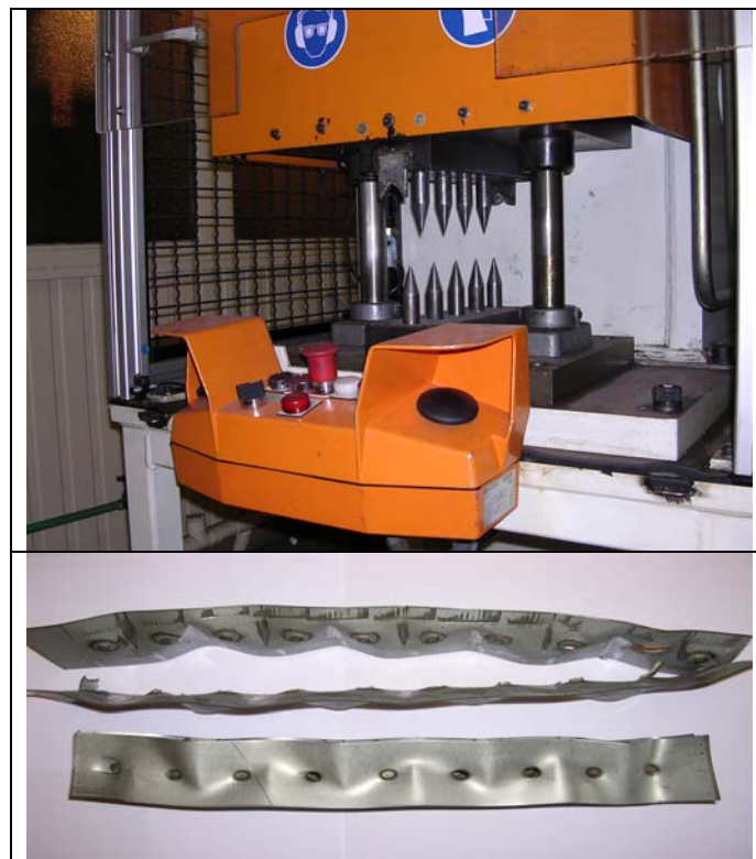
Fig. 2.8: Technique de déboutonnage des série de points soudés, a) Machine de déboutonnage «les dents de la mer», et b) Représentation d'une bande de contrôle pour l'essai de dégradation des électrodes
