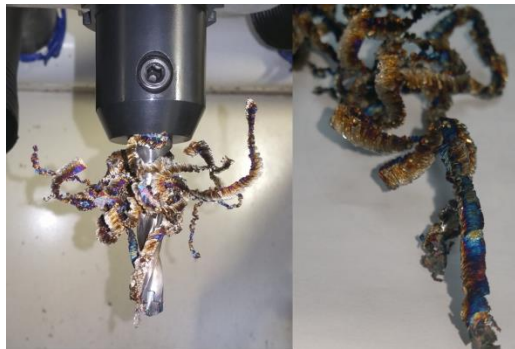
Figure II.24 : Copeaux dans le cas à sec pour V_c = 45 m/min et f = 0,08 mm/tr
