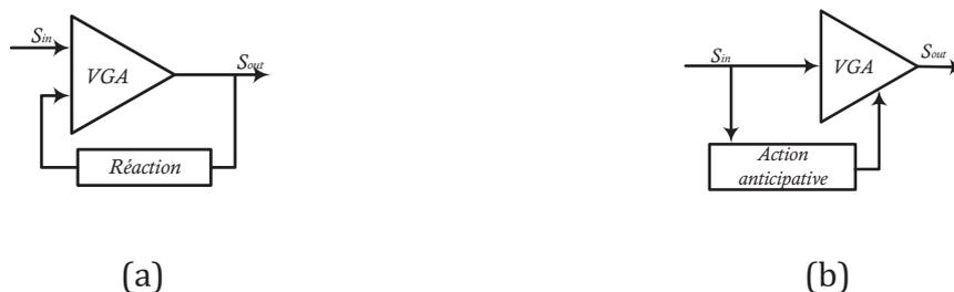
Figure I-16. Schéma bloc simplifié de l'architecture d'un AGC à réaction (a) et à action anticipative(b).
