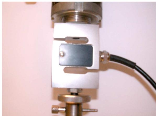
Figure 3.4 – Capteur de force utilisé lors des essais.
