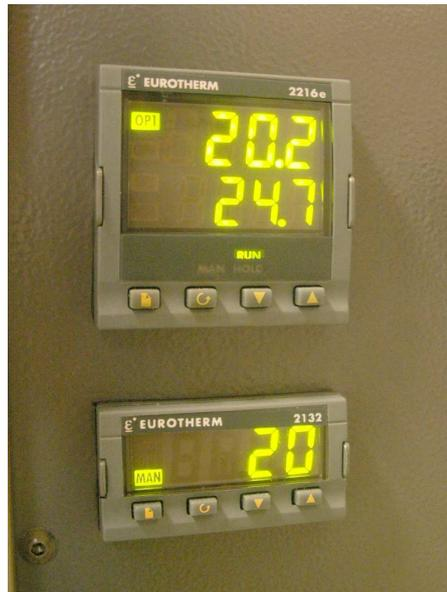
Figure 3.3 – Contrôleur de température Eurotherm.
