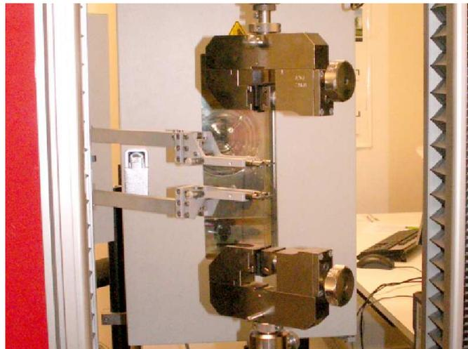
Figure 2.6 – Extensomètre électro-mécanique utilisé lors des essais de traction pour mesurer la déformation de l'éprouvette.
