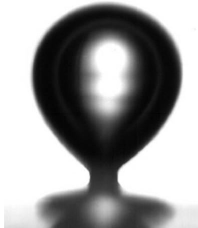
*Figure 5.26 : formation du pied lors du détachement d'une bulle dans le cas d'un fluide mouillant (Siedel, 2012)*
