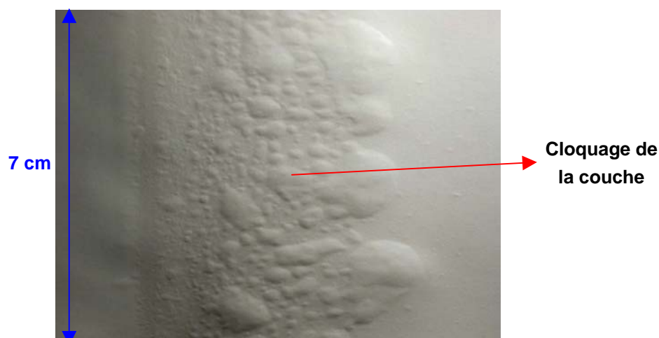
Figure 4. 17 : Cloquage de la couche au démarrage de la bobine lors d'un essai à une température du rouleau métallique de 260°C
