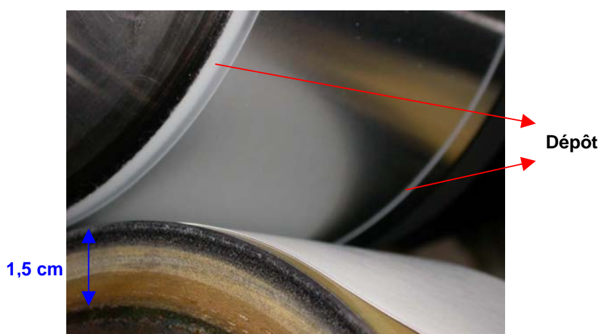
Figure 4. 15 : Dépôt observé sur le bord du rouleau métallique lors des essais avec l'ajout d'eau sous forme de spray
