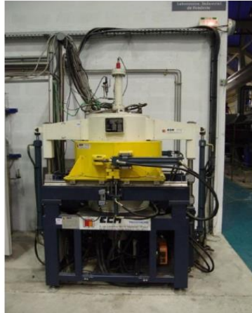
Figure VI-2 : Machine de gonflage de l'ENSAM (Boude, 1994)
