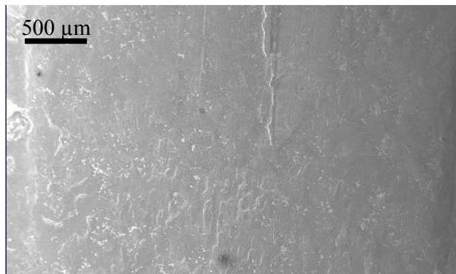
**Micrographie MEB 3.9.** *Etat de surface d'un contact en Ag-WC n'ayant pas subi d'essai
