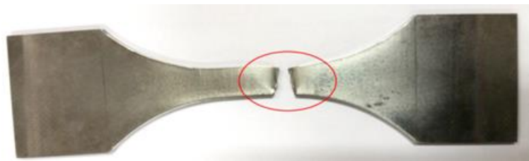
Figure II.33 : Rupture en raccord de congé d'une éprouvette de fatigue
