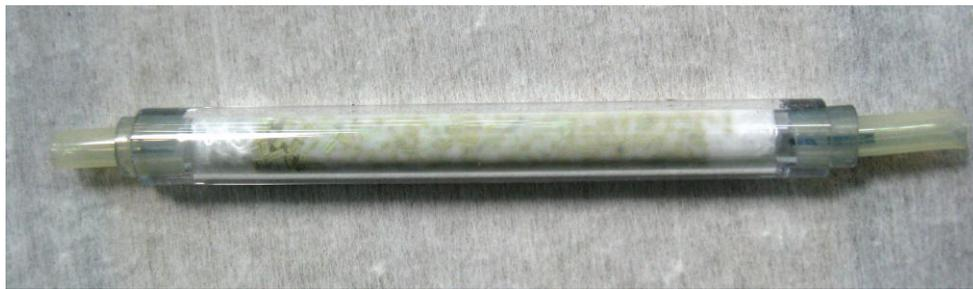
b) Liquide entrant à gauche et mouillant toutes les particules
