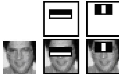
FIGURE 2.11 – Deux premiers/meilleurs descripteurs utilisés pour la détection de visages par l'algorithme de Viola-Jones. Les yeux semblent être la partie du visage permettant la meilleure discrimination par rapport au 'reste du monde'.
