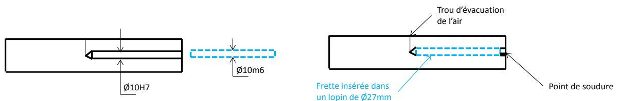
Figure 159 : Illustration de l'exemple du montage de la frette dans le moyeu pour un ajustement \text{Ø}10\text{H}7\text{m}6
