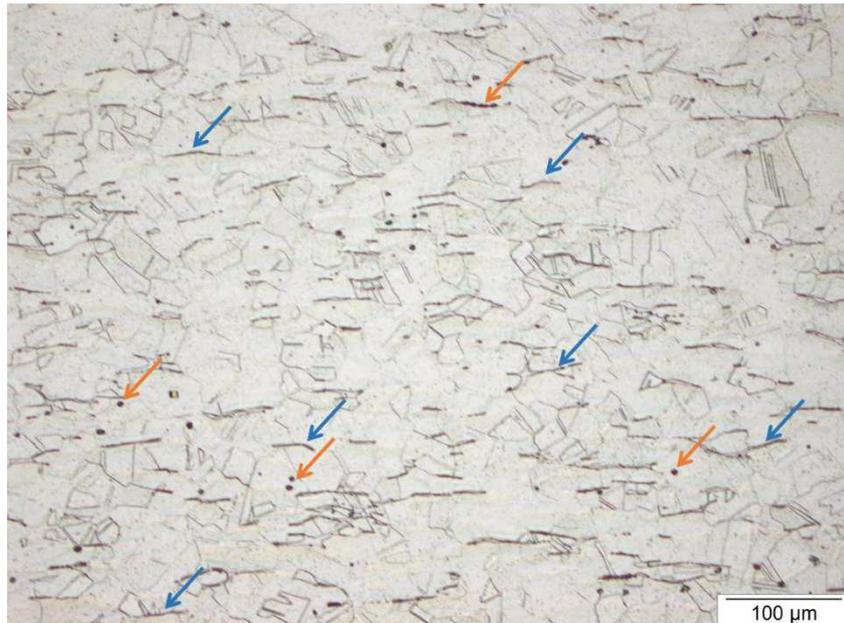
Figure 37 : Micrographie optique du matériau à l'état de réception après attaque électrochimique à l'acide oxalique 10 %, les flèches bleues pointent des bandes de ferrite résiduelle et les flèches orange, des précipités et inclusions
