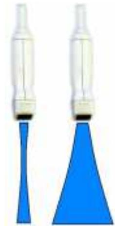
FIG. 1.5 – *Forme de la tranche ultrasonore en fonction de la profondeur. Sonde usuelle à gauche et avec une lentille défocalisante à droite.*
