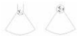
FIG. 1.2 – Balayage mécanique avec un ou plusieurs transducteurs.
