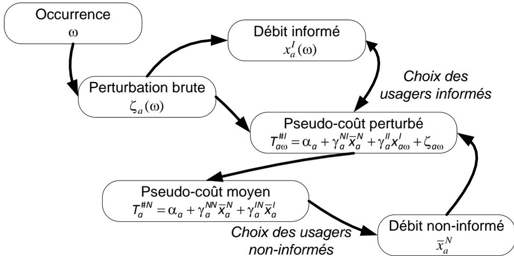
Fig. 7-4 : Les dépendances logiques dans le modèle
