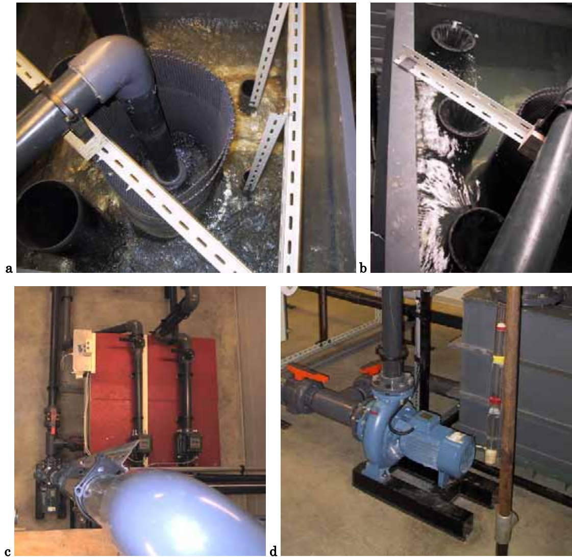
Planche 9 : vues du circuit de recirculation. (a) démarrage du remplissage du bac surélevé ; on distingue au milieu la canalisation d'alimentation et la grille de tranquillisation, à droite les deux départs des conduites d'alimentation (b) détail des colonnes déversantes en cours de fonctionnement (c) pompe de recirculation en vue plongeante bas depuis le bac surélevé, dans l'axe de la conduite qui l'alimente ; on distingue à gauche le T et les vannes des canalisations d'aspiration, à droite les portions horizontales, vannes et compteurs des canalisations d'alimentation (d) pompe de recirculation, niveau de contrôle du bac au sol (tube relié au bac, contenant une balle plastique)
