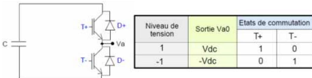
Figure 2.27 Description d'un bras de convertisseurs 2 niveaux [Gue10]
