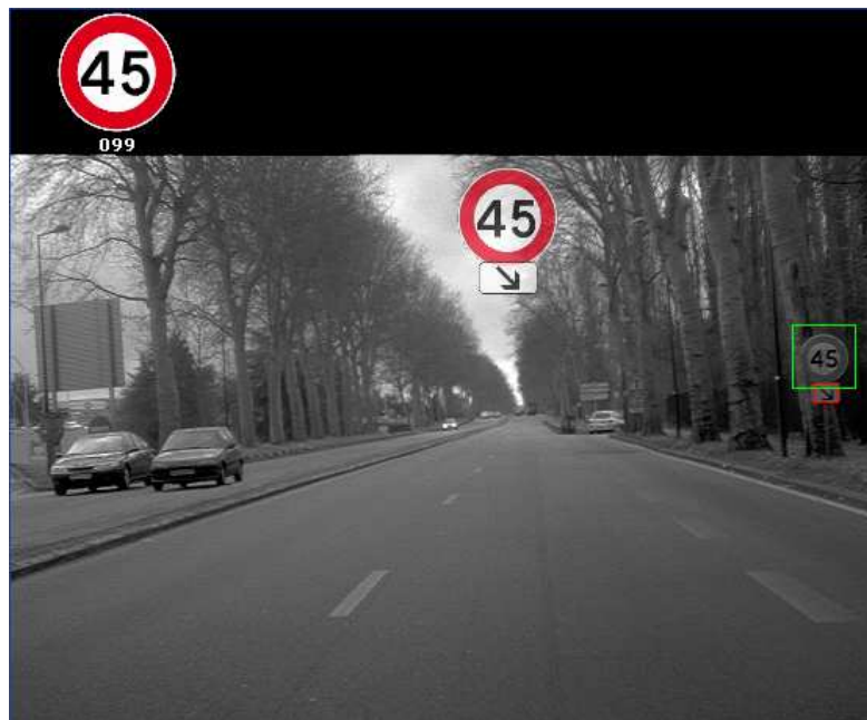
Figure 88 - Illustration d'une détection de panneau français de sortie de voie
