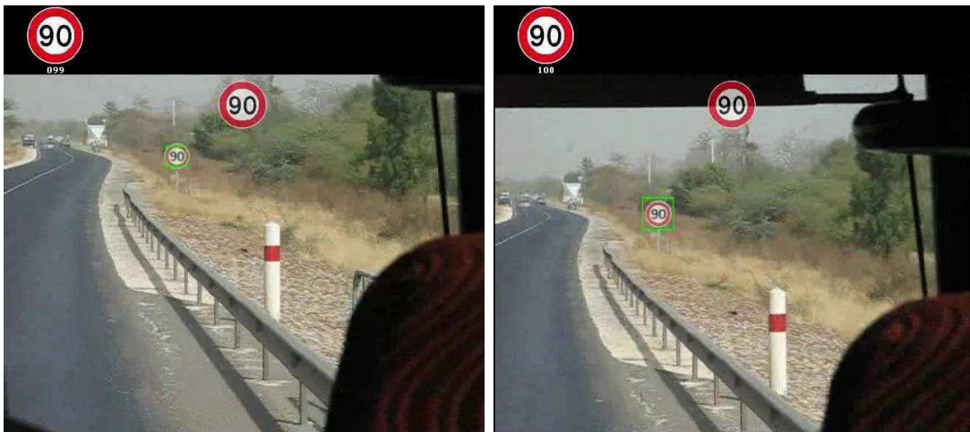
Figure 82 – Panneau de limitation de vitesse sur une séquence enregistrée (au Sénégal) avec un simple appareil photo numérique tenu à la main à bord d'un autocar (à noter la grande instabilité face au « tangage » de la vidéo, ces 2 captures étant successives)
