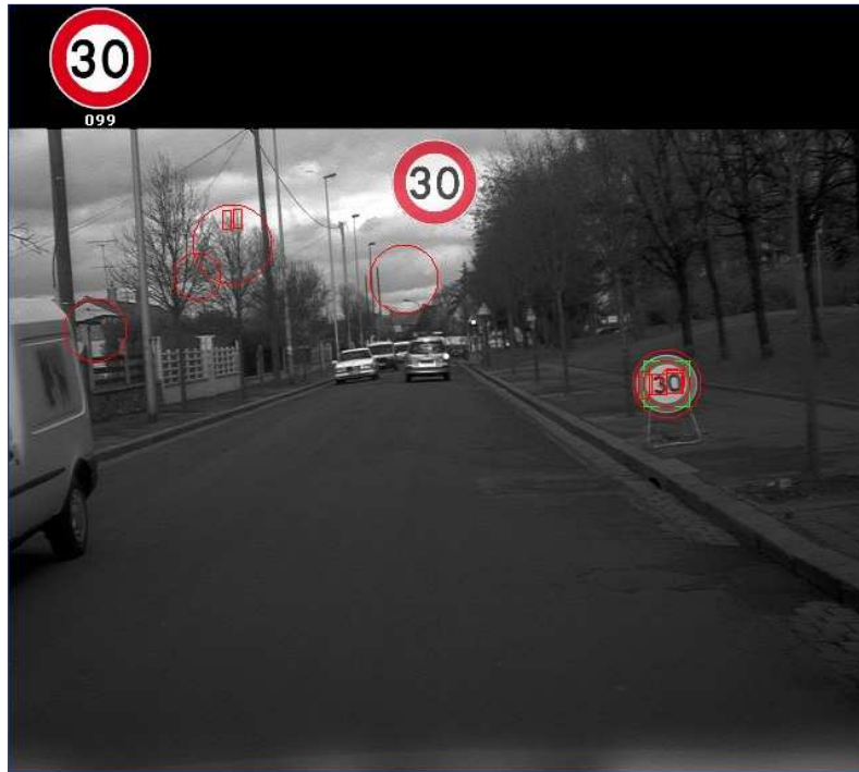
Figure 80 - Exemple de détection de panneau français. Tous les cercles détectés sont affichés en rouge, ainsi que les chiffres candidats segmentés. Tous les panneaux reconnus sont affichés en haut (dans le bandeau noir) et le panneau validé est affiché au centre de l'image (caméra SMALL 12bits).
