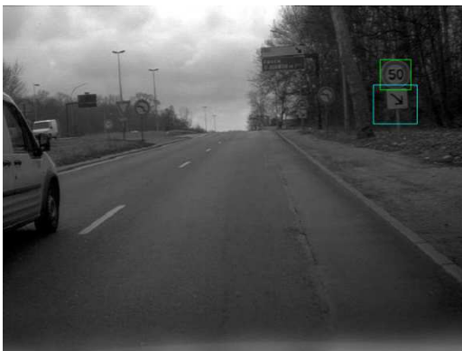
Figure 62 – Définition de la zone de recherche des panneaux
