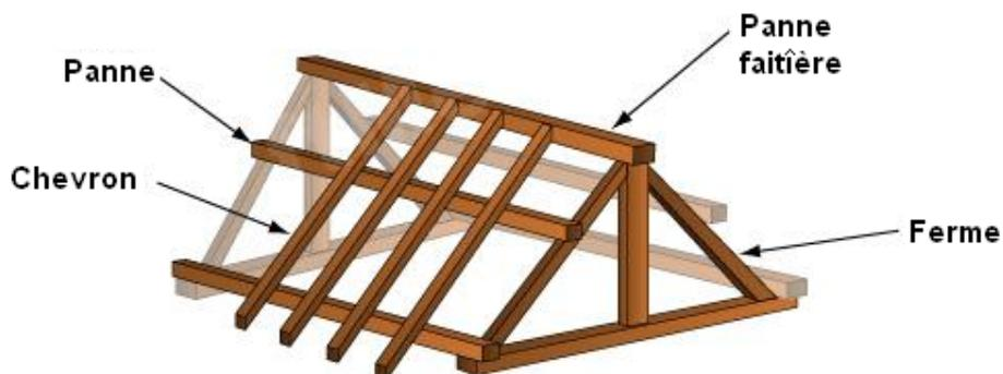
Figure 1.5 - Charpente traditionnelle pour comble aménagé
