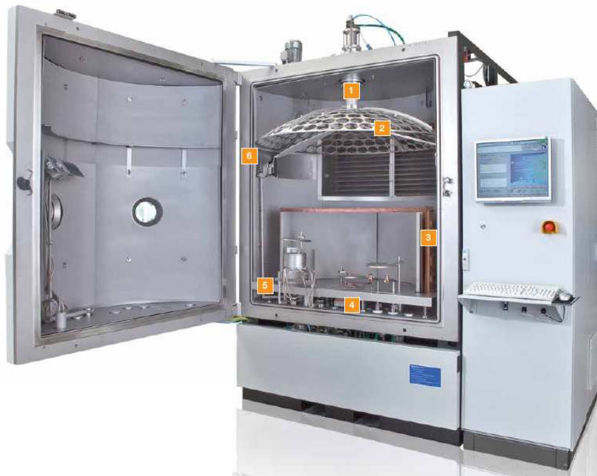
FIGURE 1.1. Machine de dépôt par évaporation thermique et par canon à électrons, modèle Syrus 1350 commercialisé par Bühler Leybold Optics [27]. Les dimensions de l'enceinte sont de l'ordre de 1 m. Les parois de l'enceinte sont en acier inoxydable poli. Le système d'évaporation par canon à électrons est situé en (4). En (3), on peut apercevoir un piège Meissner en cuivre derrière la protection métallique. Au-dessus, la grille est l'entrée de la pompe à vide. Les substrats sont disposés sur la calotte sphérique (2), appelée carousel, pour que l'angle d'incidence moyen de la vapeur soit proche de 0^\circ quelque soit leur position. Le carousel peut tourner sur lui-même pendant le dépôt, pour assurer son homogénéité.
