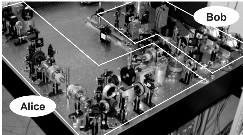
Figure 5.1: Dispositif expérimental complet. AOM : modulateur acousto-optique, MF : fibre optique monomode à maintien de polarisation, EOM : modulateur électro-optique d'amplitude, OD : densité optique, BS : lame séparatrice simulant les pertes de transmission.
