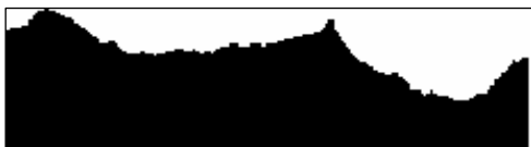
Fig. 5.16. Contour du profil obtenu par la méthode de Section Verticale sur l'éprouvette en acier inox 316L, (grossissement 50X)
