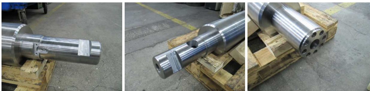
Figure 71 : Extrémités du fourreau à la fin d'usinage
