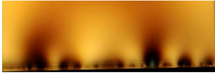
Figure 69 : Points de concentration de contrainte au contact surface verre – acier électro-érodée optimisée avec intercalage de clinquant d'épaisseur 100 µm
