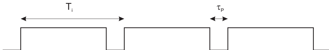
FIGURE 6 – Fonction créneau produite par le générateur d'impulsions.
