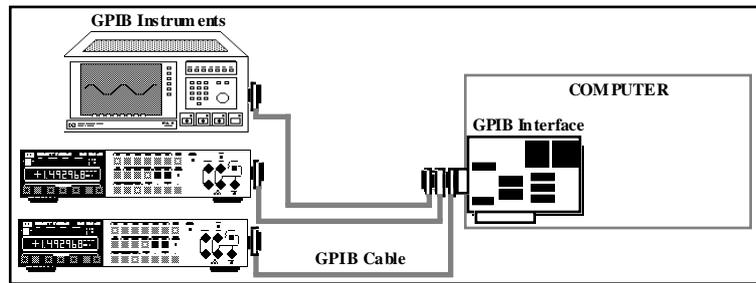
Les fonctions GPIB de LabVIEW contrôlent les interfaces GPIB de National Instruments. Vous trouverez la description et l'historique du GPIB, ou de l'IEEE 488, dans la section intitulée *GPIB Overview* du chapitre 1, *Introduction*, dans le *LabVIEW Instrument I/O VI Reference Manual*. LabVIEW utilise le logiciel standard NI-488.2 de National Instruments, livré avec votre interface GPIB.
