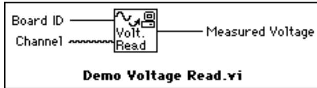
Le VI **Demo Voltage Read** simule la mesure d'une tension acquise sur le canal 0 d'une carte d'acquisition enfichable. Le VI multiplie alors la tension par 100.0 pour la convertir en une température exprimée en degrés Fahrenheit.
