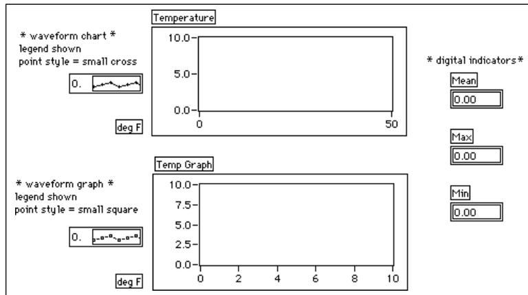
1. Ouvrez une nouvelle fenêtre puis construisez la face-avant reproduite dans l'illustration précédente. Vous pouvez modifier les styles des points des graphes déroulants et des graphes oscilloscopiques en ouvrant un menu local sur leurs légendes.
