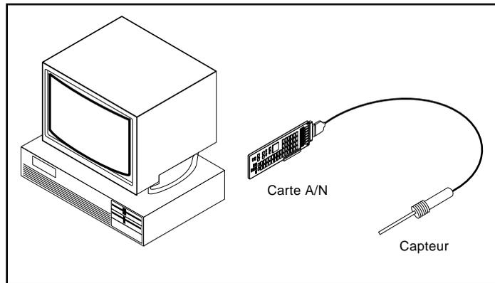
**(HP-UX)** Le capteur pourrait aussi bien être connecté à un convertisseur analogique-numérique connecté à l'ordinateur via une interface GPIB, comme dans l'illustration suivante. Cette méthode permet aussi de convertir la tension en données numériques.
