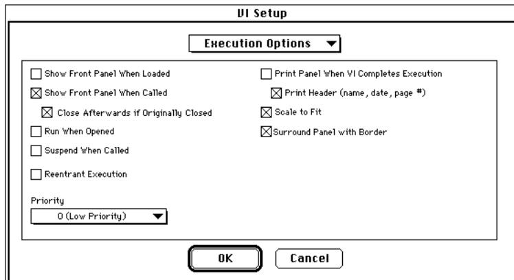
Configurez les options **Execution Options** en retenant tous les paramètres sélectionnés dans l'illustration précédente. Puis, modifiez les options **Window Options** pour obtenir une configuration semblable à celle de l'illustration suivante.
