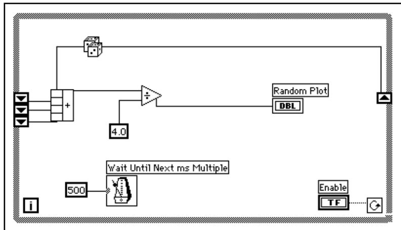
1. Ajoutez **While Loop (Functions»Structures)** dans le diagramme et créez le registre à décalage.
