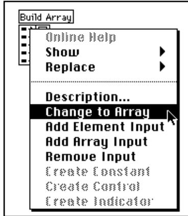
Ensuite, câblez les tableaux et les scalaires au nœud. Le tableau de sortie est un tableau à une dimension composé des éléments du tableau 1, du scalaire 1, du scalaire 2, des éléments du tableau 2 et du scalaire 3, comme illustré ci-dessous.
