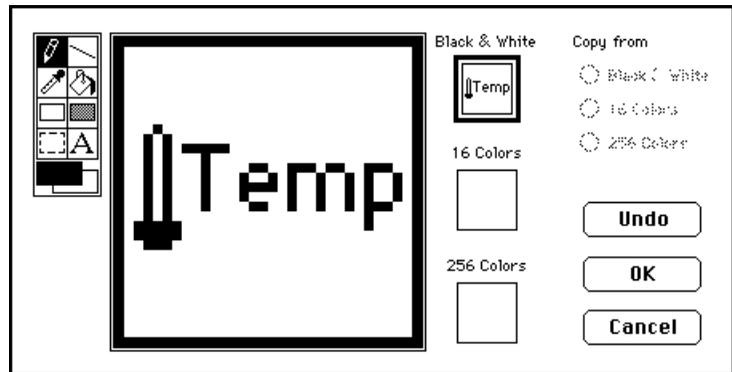
7. Fermez l'Editeur d'icônes en cliquant sur le bouton **OK** une fois l'icône terminée. La nouvelle icône apparaîtra dans le cadre icône en haut à droite de la face-avant.
