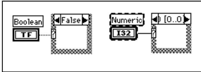
Vous ne pouvez afficher qu'une seule condition à la fois. Pour passer d'une condition à l'autre, il suffit de cliquer sur les flèches qui figurent en haut de la structure Condition.
