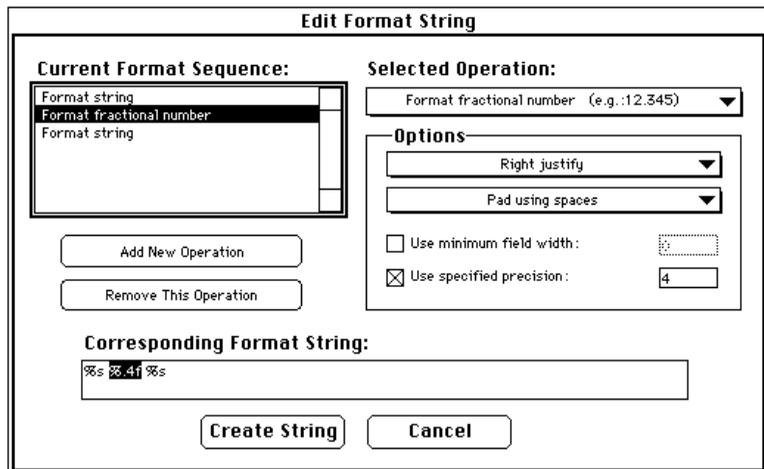
3. Appuyez sur le bouton **Create String**. Le seul fait d'appuyer sur ce bouton insère automatiquement les informations nécessaires pour obtenir le format qui convient et câble le format de la chaîne à la fonction.
