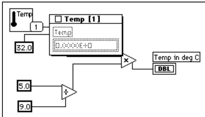
3. Retournez dans la face-avant. Déplacez la fenêtre de la sonde de manière à visualiser les valeurs de la sonde et celles du thermomètre conformément à l'illustration suivante. Lancez le VI. La température exprimée en degrés Fahrenheit s'affiche dans la fenêtre de la sonde.
