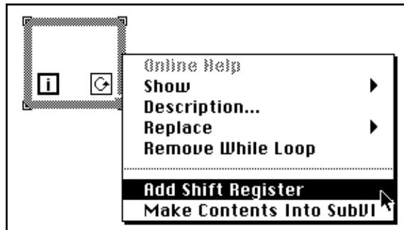
Le registre à décalage contient deux terminaux situés de part et d'autre des bords verticaux du cadre de la boucle. Le terminal *de droite* stocke les données pendant toute l'itération. A la fin de l'itération, elles se décalent et apparaissent dans le terminal *de gauche* au début de la
