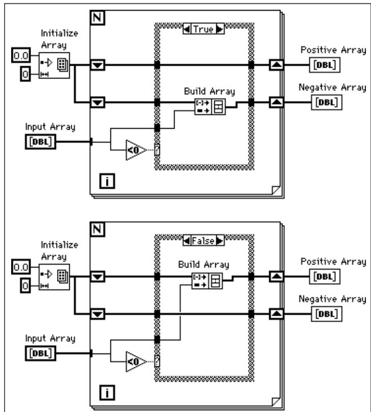
Vous remarquerez que le câble qui part de Input Array change d'épaisseur à l'extérieur de la boucle *For*, indiquant par là qu'il véhicule un tableau. Il s'affine à l'intérieur de la boucle, indiquant par là qu'il s'agit d'un élément unique. Le  $i^{\text{ème}}$  élément du tableau est automatiquement indexé à chaque itération.
