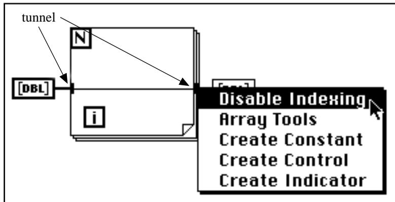
LabVIEW désactive automatiquement l'auto-indexation pour tous les tableaux câblés à une boucle *While*. Il suffit d'ouvrir un menu local sur le tunnel du tableau d'une boucle *While* pour activer l'auto-indexation.
