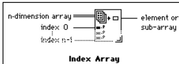
La fonction **Index Array** vous permet d'accéder à un élément particulier d'un tableau. Dans l'exemple suivant, la fonction **Index Array** sert à accéder au troisième élément d'un tableau. Vous remarquerez que l'indice du troisième élément a pour valeur 2 puisque le premier élément a un indice égal à 0.
