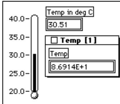
4. Fermez la fenêtre de la sonde en cliquant sur le bouton de fermeture en haut à gauche de sa barre d'outils.
