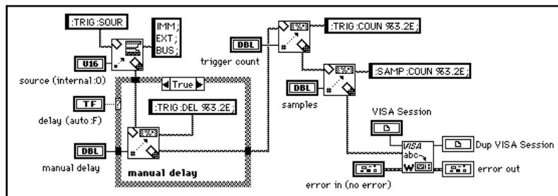
Vous remarquerez que le driver d'instrument n'est rien d'autre qu'un ensemble de fonctions de manipulation de chaînes de caractères pour construire les commandes à adresser à l'instrument. Dans cet exemple, on utilise un VI **VISA Write**, qui envoie la chaîne de commande aux instruments GPIB ou VXI.
