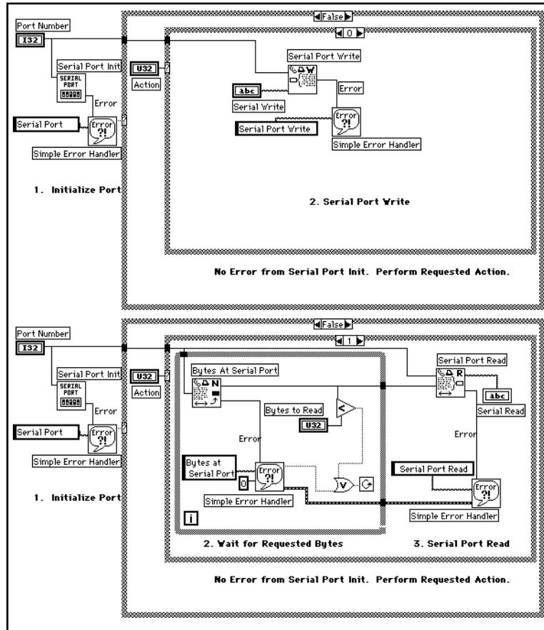
1. Ouvrez le diagramme du VI **LabVIEW** <-> **Serial**, reproduit en partie dans l'illustration ci-dessus, et examinez les fonctions mises en œuvre pour communiquer via le port série conformément à la méthode décrite précédemment. Cliquez sur les flèches situées en haut des structures pour étudier le diagramme dans son intégralité.
