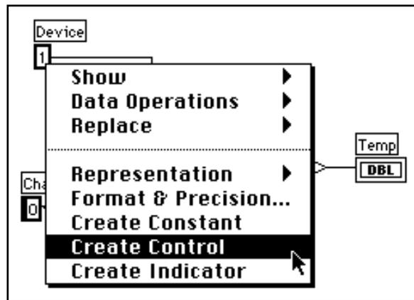
Pour un terminal fonctionnant comme une sortie dans le diagramme, vous pouvez choisir la fonctionnalité **Create Indicator** pour créer puis câbler un indicateur au terminal. Vous accédez à cette fonctionnalité en ouvrant un menu local sur le terminal et en choisissant **Create Indicator**. LabVIEW crée et câble automatiquement le bon type d'indicateur à la sortie du terminal.
