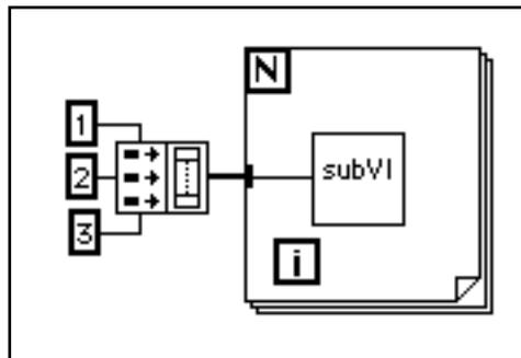
Si le tableau contient des éléments constants, vous pouvez utiliser un tableau de constantes plutôt que construire un tableau dans le diagramme.
