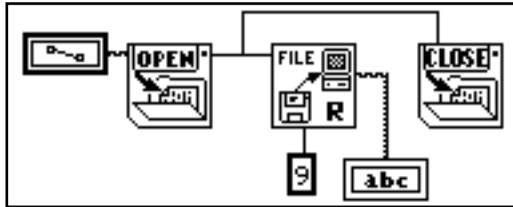
La version suivante du diagramme établit une dépendance en câblant une sortie de **Read File** sur **Close File**. L'opération ne peut pas s'interrompre avant que **Close File** n'ait reçu la sortie de **Read File**.
