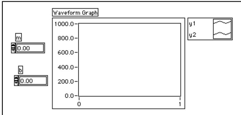
1. Ouvrez une nouvelle fenêtre de face-avant puis construisez la face-avant présentée dans l'illustration précédente. L'indicateur du graphe oscilloscopique affiche les tracés de l'équation. Le VI utilise les deux commandes numériques pour entrer les valeurs à attribuer à  $m$  et à  $b$ .
