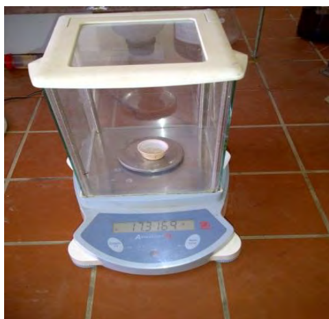
Figure 7: Balance de précision utilisée pour la pesée de la prise d'essai
