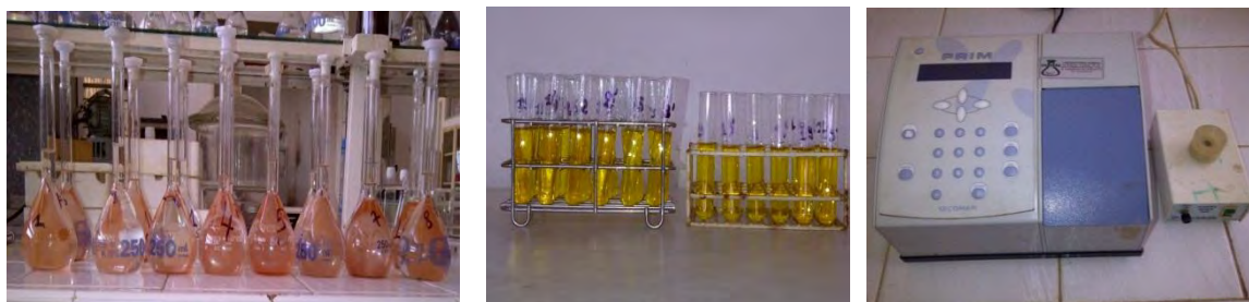
Figure 14: Fioles contenant les solutions aliquotes (à gauche), tubes permettant la réaction de mission et spectrophotomètre utilisé pour la lecture des densités optiques lors du dosage du phosphore total dans les échantillons de farine de poisson.
