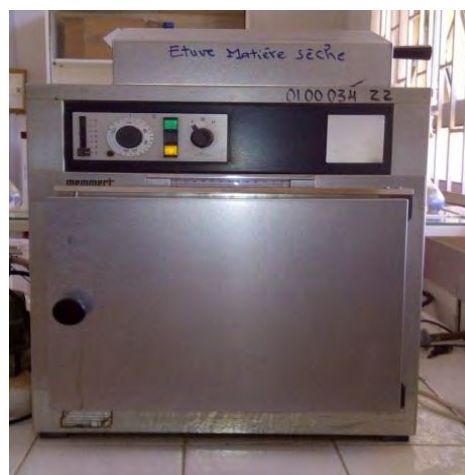
Figure 8: Etuve réglable utilisée pour le dosage de la matière sèche
