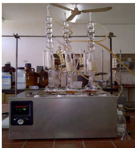
Figure 12: Appareil de soxhlet ou dispositif d'extraction des matières grasses contenues dans les échantillons de farines de poisson
