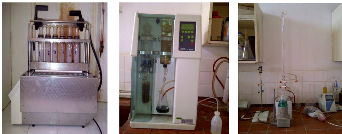
Figure 11: Dispositifs de minéralisation (à gauche), de distillation (au milieu) et de titration (à droite) utilisés lors du dosage des protéines brutes
