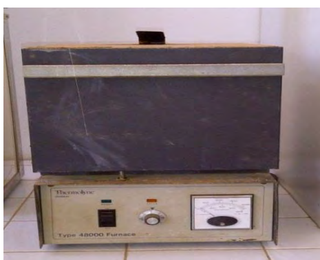
Figure 9: Four à moufle utilisé pour l'incinération des prises d'essai
