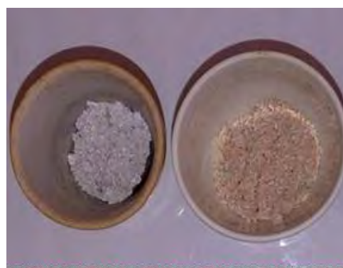
Figure 10: Creusets contenant des cendres gris-claire (à gauche) et gris-sombre (à droite) de farine de poisson
