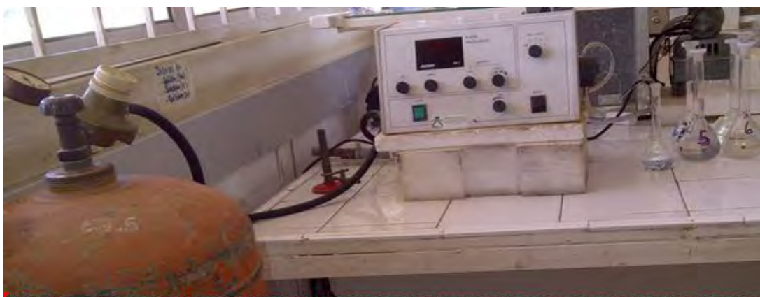
Figure 13: Photomètre à flamme utilisé pour les mesures de densité optique lors du dosage du sodium (Na), potassium (K) et de calcium (Ca) dans les échantillons de farine de poisson
