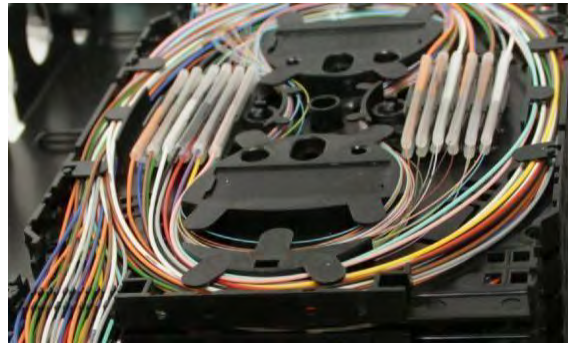
FIGURE 49: COUPLEURS OPTIQUES SANS CONNECTEURS
