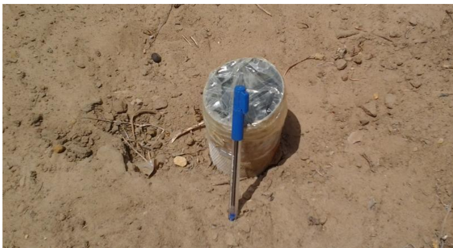
Figure 29 : Sondage équipé de PVC
