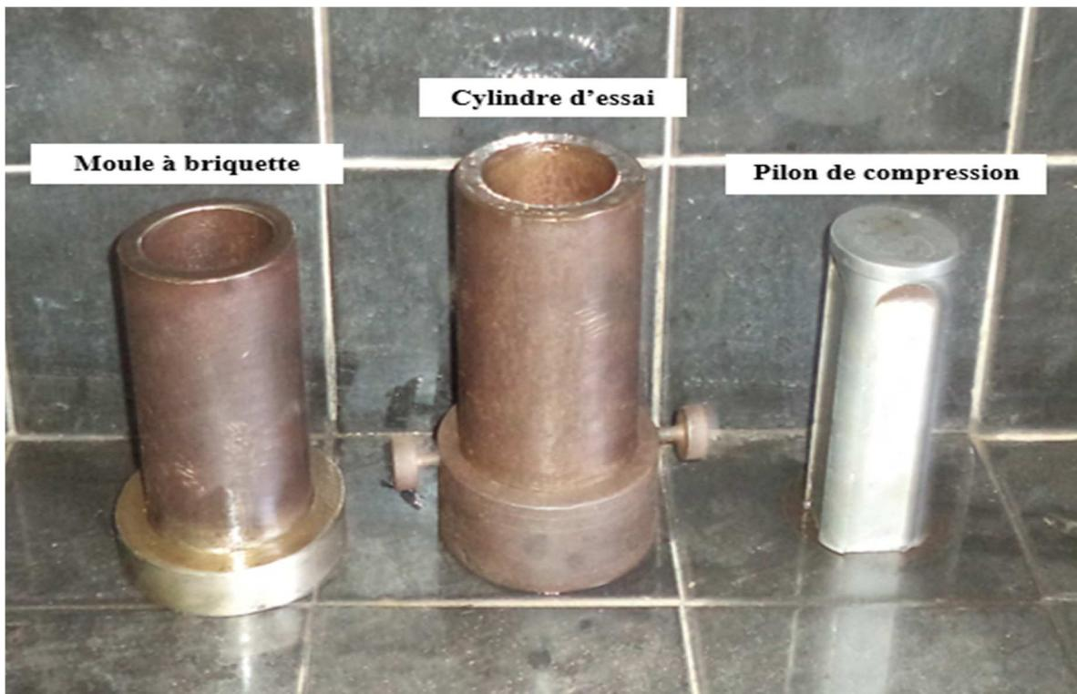
**Figure 14 : Appareils Hubbard-Field**
