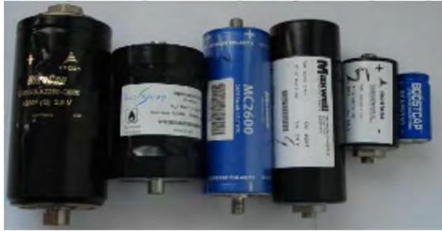
Figure I.9 Image des supercondensateurs
