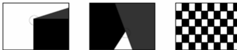
Figure 4 : Différents types de points d'intérêt : coins, jonction en T et point de fortes variations de texture.
