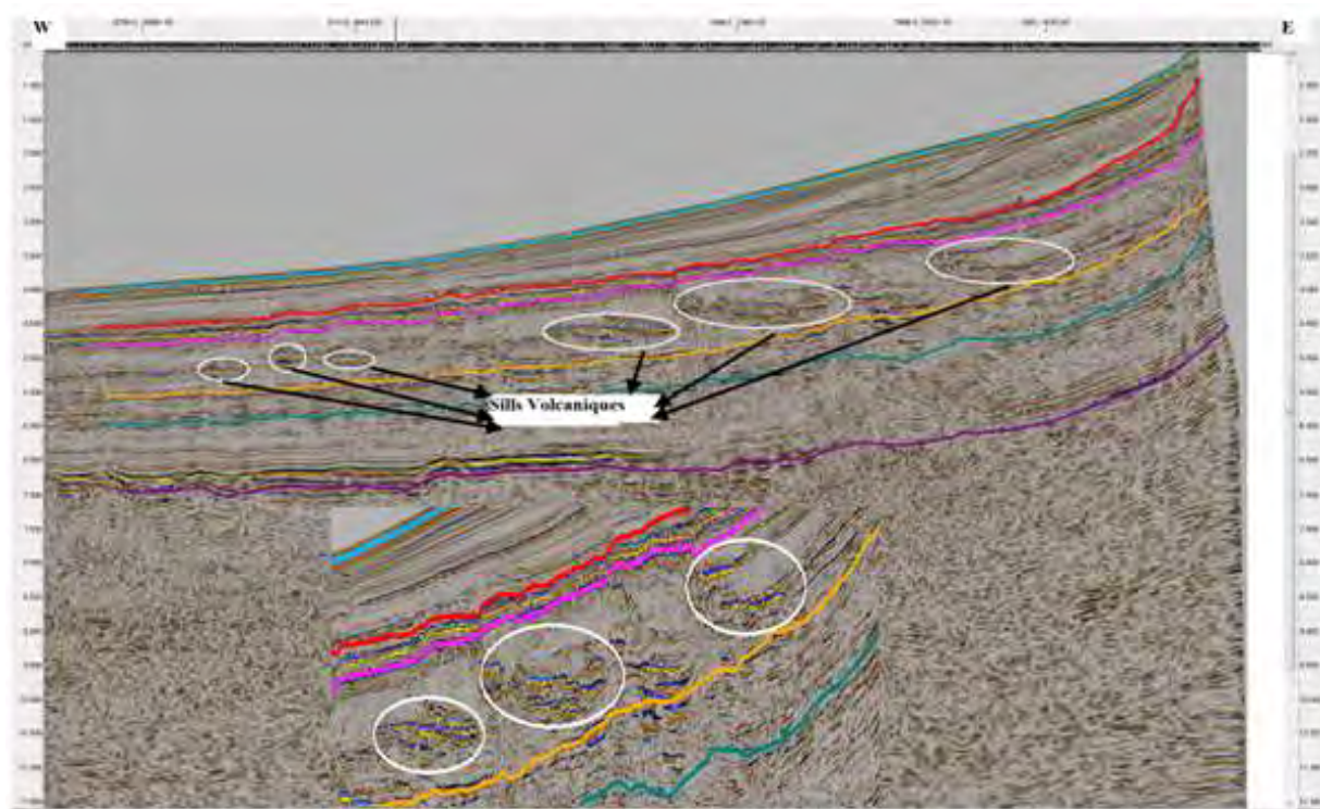
Figure 34 : Section sismique de la ligne L1 montrant des sills volcaniques.
