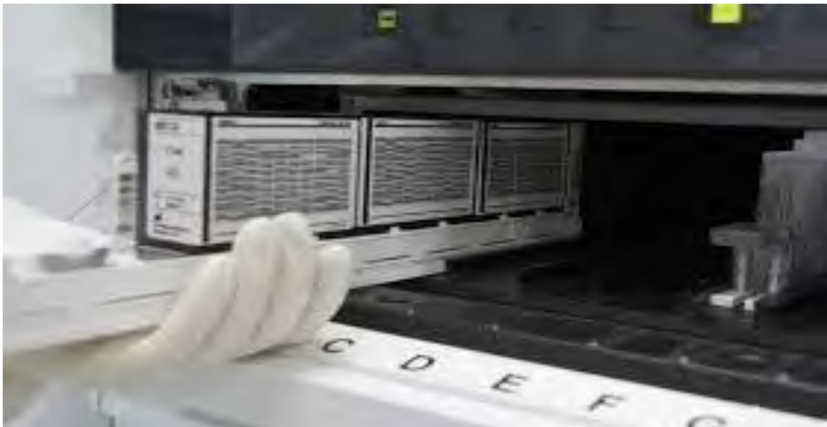
*Figure 39 : Chargement d'un rack de réactif contenant les cassettes C2, C3 et C4 en position B.*
