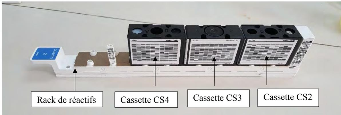
*Figure 38 : Rack de réactifs chargé de cassettes CS2, CS3 et CS4*
