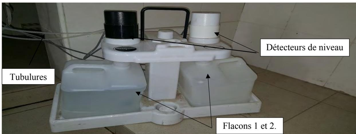
Figure 20 : Récipients de lavage raccordés aux connecteurs de tubulure de l'AmpliPrep.
