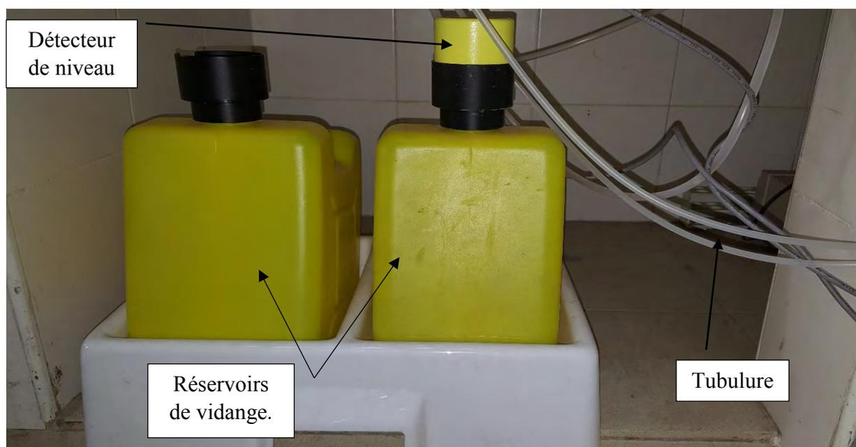
*Figure 21* : Réservoirs de vidange raccordés aux connecteurs de tubulure de l'Appareil.
