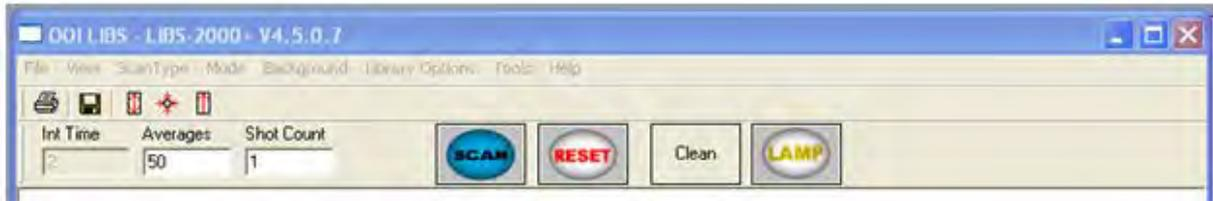
La technique consiste à régler le Scan Type sur spectromètre, puis enregistrer le background après l'avoir chargé. Ensuite réglé le Scan type en single shoot et paramétré le Q-Switch Delay par Tools.
