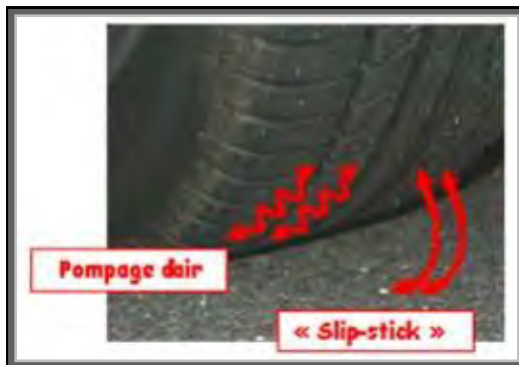
Figure 4 : Bruit dû au phénomène de pompage d'air (COLAS, 2006)
