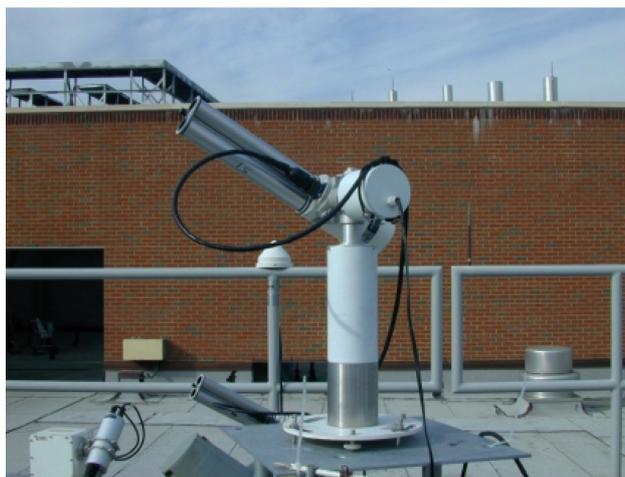
Fig. 3.17 : Photographie d'un photomètre solaire CIMEL réalisant un visée directe du soleil
