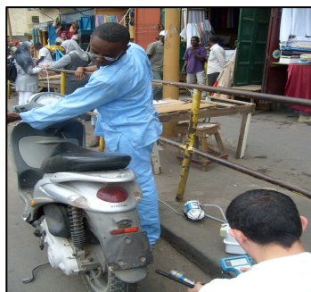
Fig. 2.3 : Mesure des facteurs d'émissions de véhicules à deux roues à Dakar (Sénégal) en 2009.
