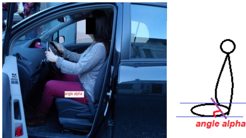
Figure 2 : de profil pour mesurer l'angle alpha et schématisation
