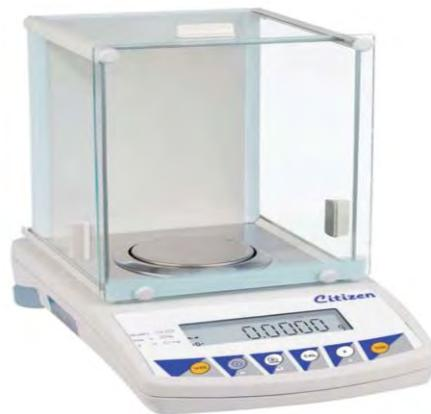
**Figure II-7 Balance utilisée pour la pesée des particules de poussière**
