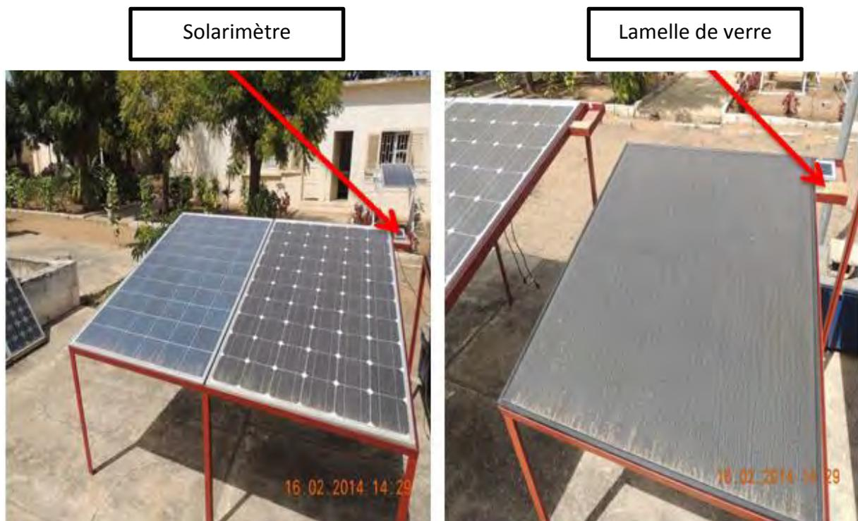
**Figure II-6** Plateforme des trois technologies utilisées pour la densité de poussière
